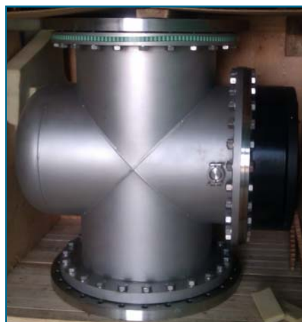
Fot. 4 Widok reaktora 900 mm przed zamontowaniem.
